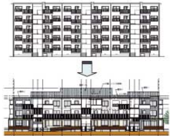
図9 上部2層減築による外観の変化
