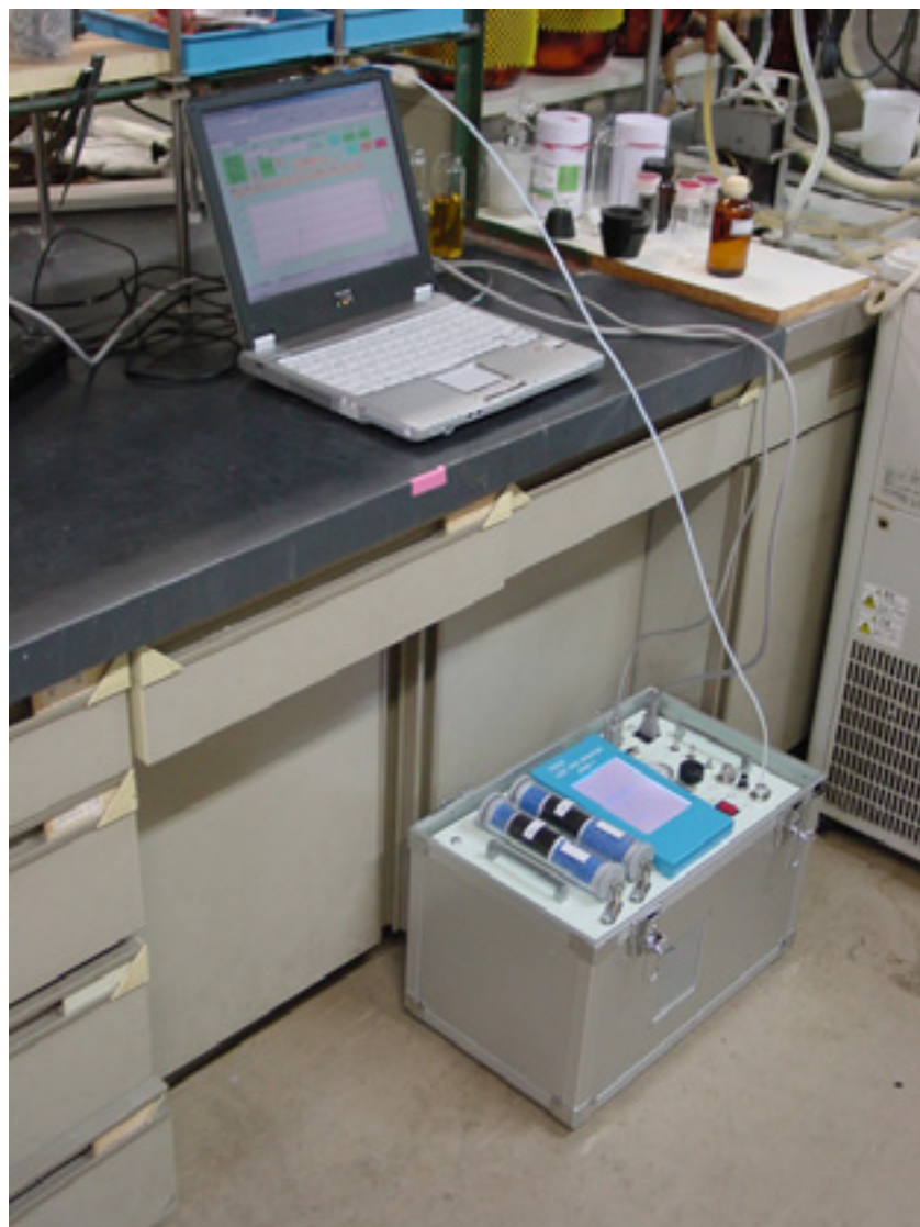
写真1 小型 VOCs 分析装置を用いての実験室内での VOCs モニタリング
